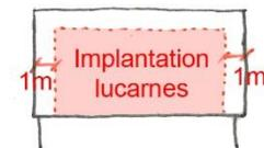
La largeur d'une ouverture en toiture doit être inférieure ou égale à 2,00 m.
